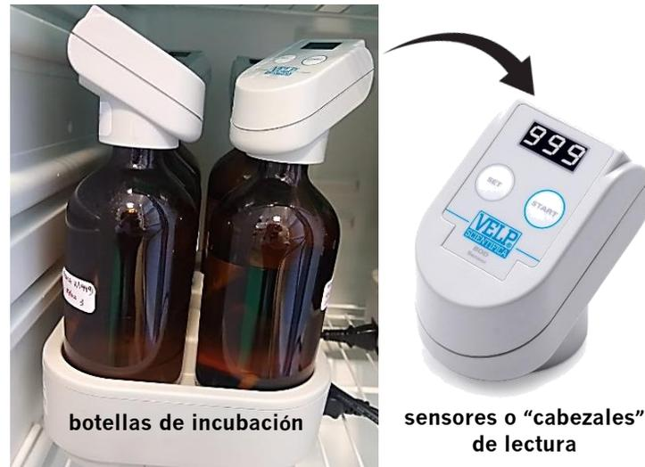
**Figura 15.** Fotografía del sistema comercial utilizado para la estimación de la DBO<sub>5</sub>.
