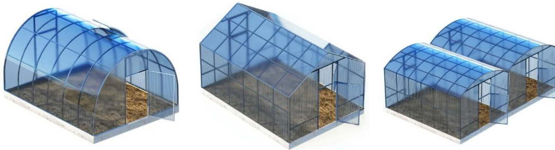
Fig.7: Tipos de invernaderos: Túnel, Capilla y Multicapilla
