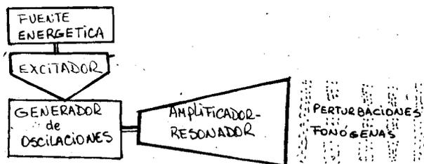
(I) **Fuente energética**: De ella se obtiene la energía necesaria para la oscilación. Ejemplo: sistema respiratorio, fuelle, músculos del brazo y mano. La fuente energética no oscila.
