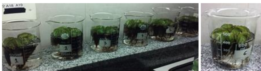
Fig. 3. Fotografías representativas de los sistemas en lote utilizados para la evaluación de la capacidad fitorremediadora de pesticidas por especímenes autóctonos de S. biloba .
