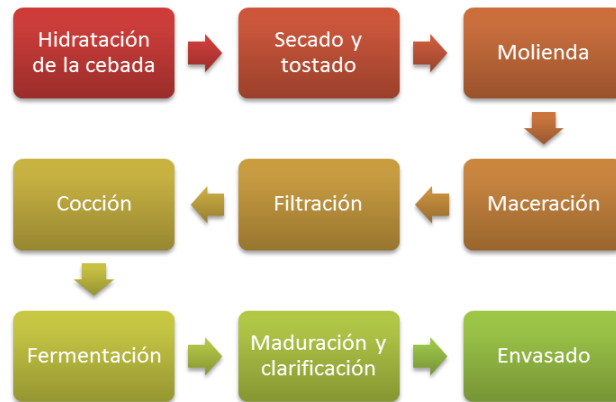
Figura 2: Esquema de las operaciones involucradas en el proceso de elaboración de cerveza. Fuente: elaboración propia, adaptado de Back y col., 2020.
