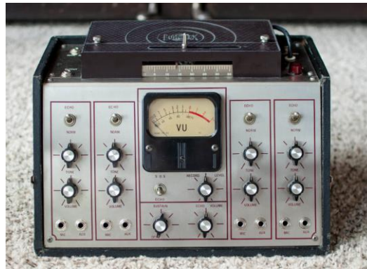
Figura 2.2.2 - Equipo de efectos Echoplex con tecnología valvular.
