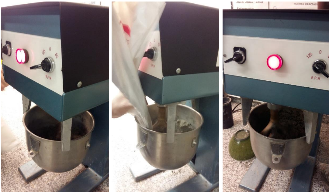
Ilustración 26: Mezcla inicial a 62 rpm (izquierda), agregado de cemento y cenizas (centro), mezclado final a 125 rpm (derecha)
