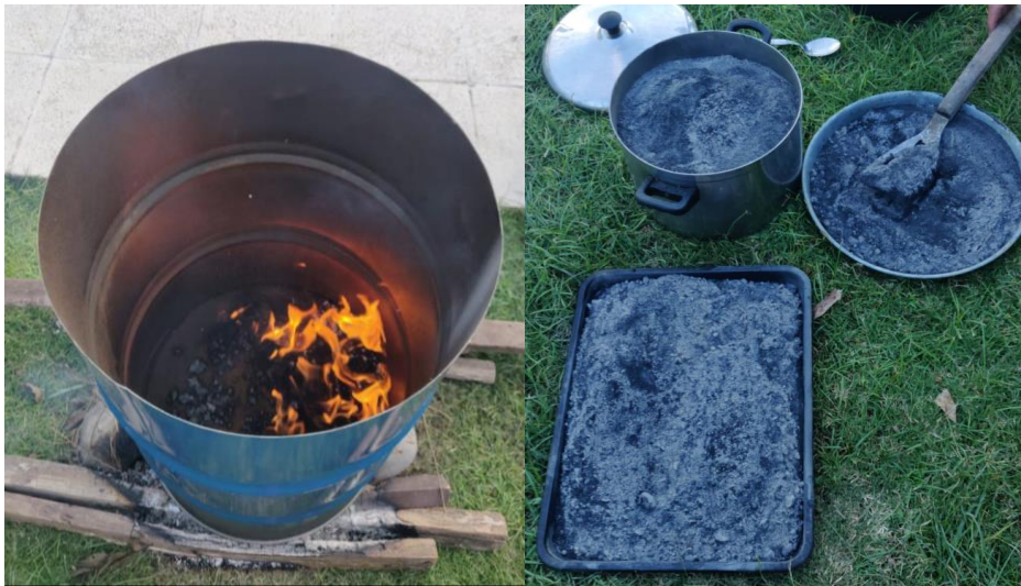
Ilustración 10: Proceso de quema del polvo de tabaco (izquierda) y de enfriamiento de las cenizas obtenidas (derecha)
