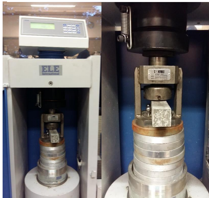
Ilustración 18: Compactación de probetas prismáticas
