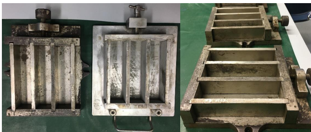
Ilustración 14: Moldes para elaboración de probetas prismáticas
