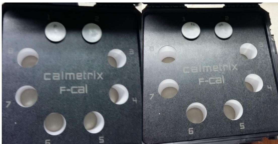
Ilustración 24: Medición de las muestras patrón y con 10% de ceniza en canales 1 y 2 (izquierda), medición de las muestras con contenido del 15% y 5% de ceniza en canales 1 y 2 (derecha)
