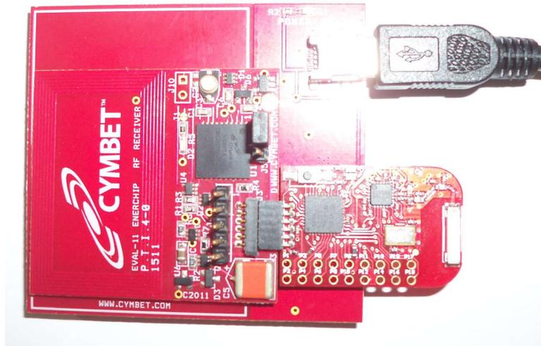
Figura 3.5: Imagen de un nodo alimentado por medio de RF.
