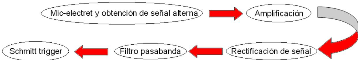
**2.3.1 – MIC-electret y obtención de señal alterna**
